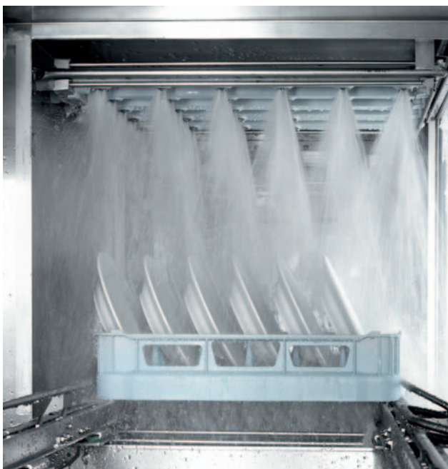
Bez nepřetržitého posuvu košů: nedochází k rovnoměrnému kontaktu s oplachovací vodou*
