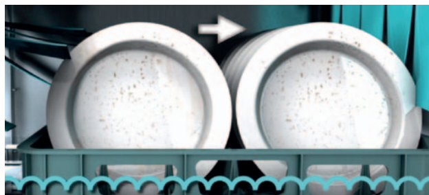
S nepřetržitým posuvem košů: rovnoměrný kontakt s oplachovací vodou*
