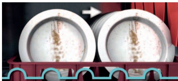
Bez nepřetržitého posuvu košů: nedochází k rovnoměrnému kontaktu s oplachovací vodou*
